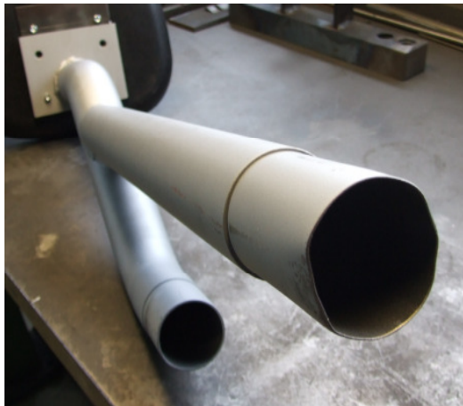
Bild 47: Schadensfall nach Strahlen
