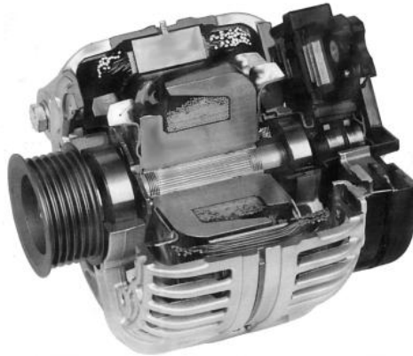
Bild 3.4: Kompakt- Drehstromgenerator [7 S.26]
