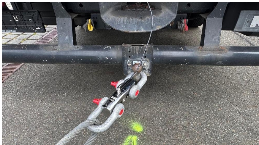
Abbildung 3.10: Einbindung der Kraftmessdose in die Zugkette
