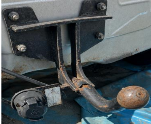
Abbildung 4.8: Anhängerkupplung nach dem 15 km/h Zugversuch
