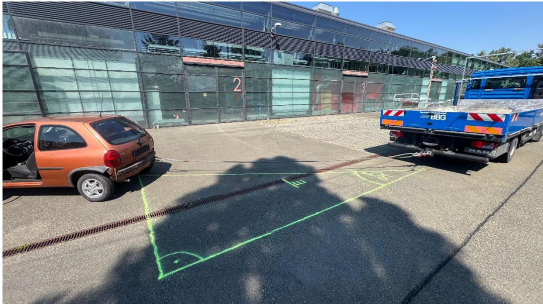
Abbildung 4.5: Grundaufbau des realen Zugversuchs, am Beispiel des Opel Corsa mit Abschleppöse
