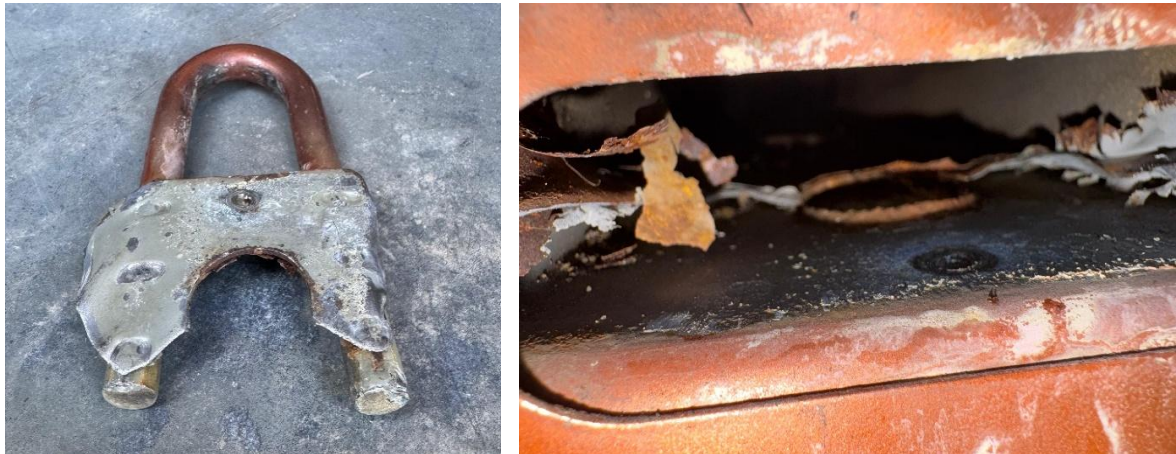
Abbildung 4.11: Abgerissene Abschleppöse & Stelle an der Karosserie
