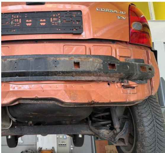
Abbildung 4.1: Heckansicht der beiden Versuchsfahrzeuge mit den unterschiedlichen Krafteinleitungspunkten
