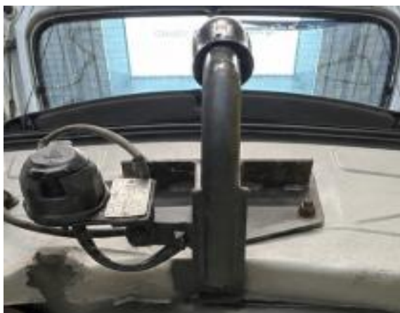
Abbildung 4.7: Anhängerkupplung nach dem 5 km/h Zugversuch
