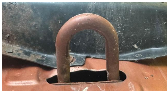
Abbildung 4.10: Abschleppöse nach dem 5 km/h Zugversuch
