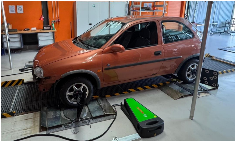
Abbildung 3.13: Bosch FWA 4630 zur Vermessung der Achsgeometrie
