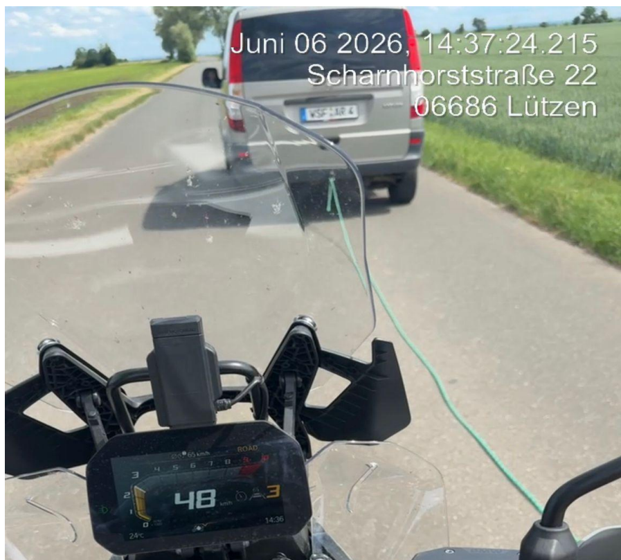
Abbildung 33: Versuchsaufbau Fahrerperspektive mit eingehaltenem Abstand vor Bremsversuch: [Eigene Darstellung] [40]
