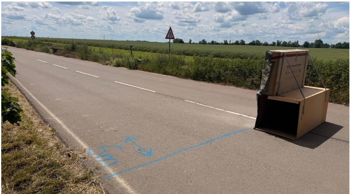
Abbildung 21: Versuchsaufbau mit Karton als Hindernis und 5m Markierung: [Eigene Darstellung] [40]
