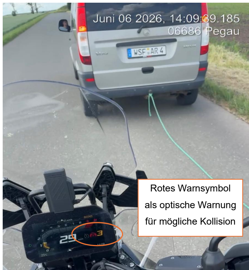
Abbildung 27: Versuch mit Aktivierten FCW und rotem Symbol als Warnung für mögliche Kollision: [Eigene Darstellung] [40]
