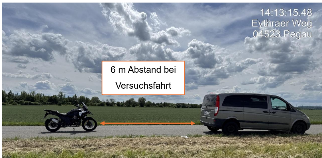
Abbildung 34: Versuchsfahrt mit Auto als bewegtes Hindernis 6m voraus: [Eigene Darstellung] [40]
