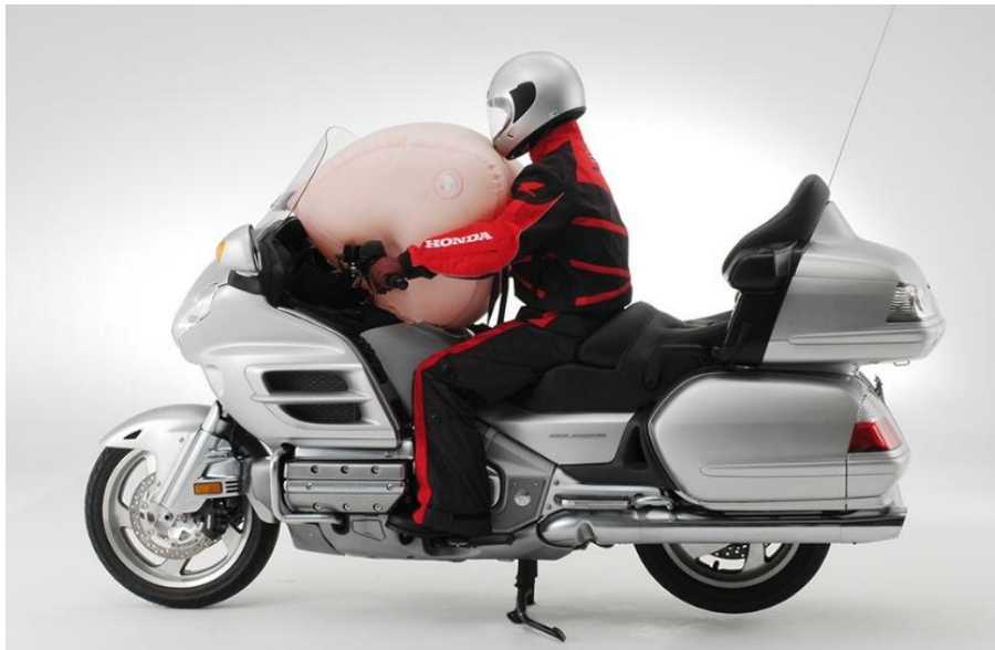
Abbildung 7: Ausgelöster Gold Wing Airbag: [21]
