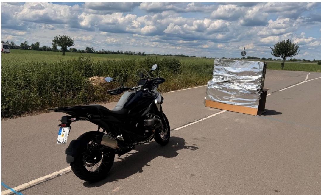
Abbildung 31: Versuch mit eingezogenem Hindernis und Bremsung ohne FCW bis zum Stillstand: [Eigene Darstellung] [40]
