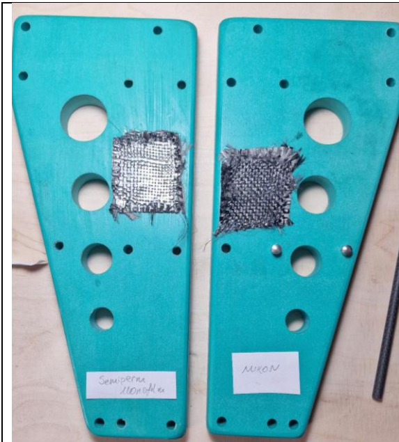
Abbildung 11: Testen der Oberflächenreinheit und der Antihafteffekt nach dem Auftragen von Versiegler und Trennmittel.
