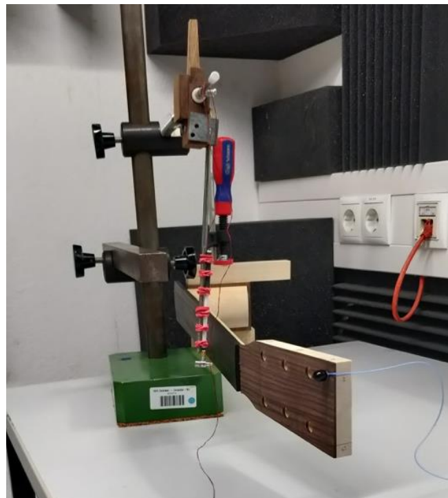
Abbildung 4.5: Versuchsaufbau Kontaktmessung Ono Sokki CF-7200
