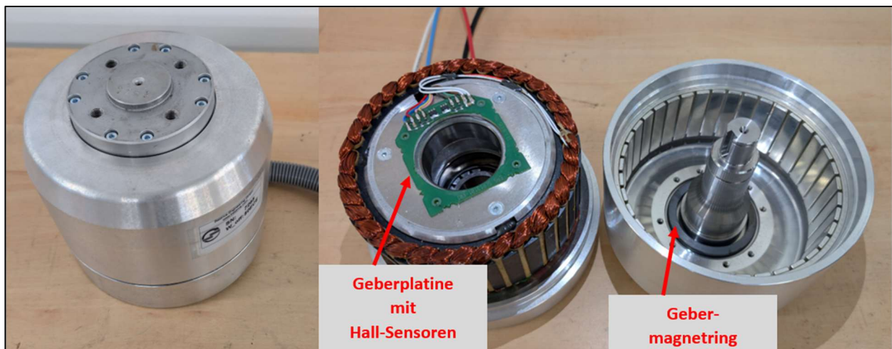
Abbildung 3: Darstellung eines AEC140/54 im fertigen Zustand (links) und geöffnet (rechts)
