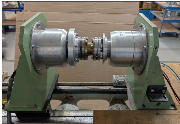
Abbildung 30: Aufbau Motorstrang des neuen Prüfstands
