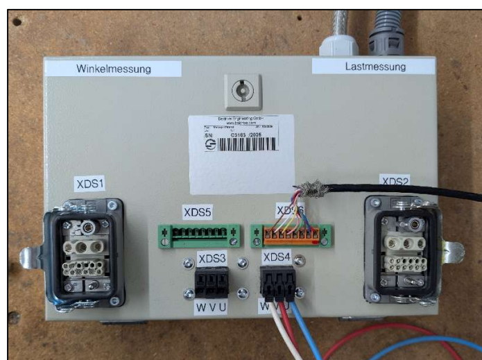
Abbildung 31: Verteilerbox für Motoranschluss Prüfling
