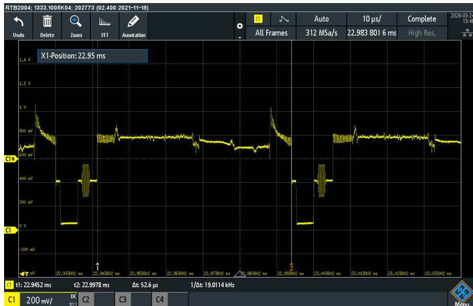
Abbildung 29 Oszillogramm einer Bildzeile des CVBS der Kamera, mit Messung der sichtbaren Bildzeilendauer
