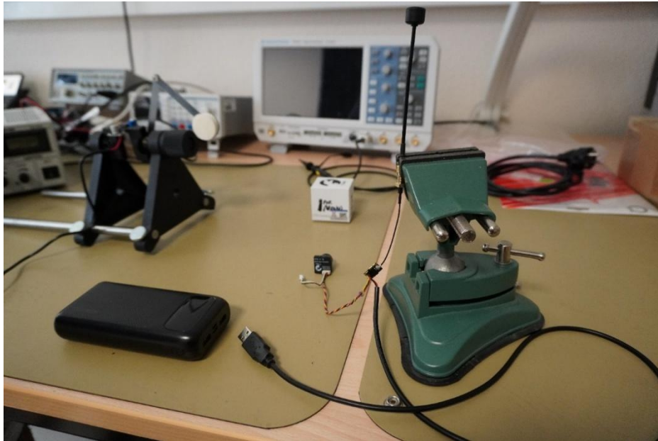
Abbildung 31 Versuchsaufbau zum Nachweis der Funktionsfähigkeit der Funkverbindung auf der Senderseite
