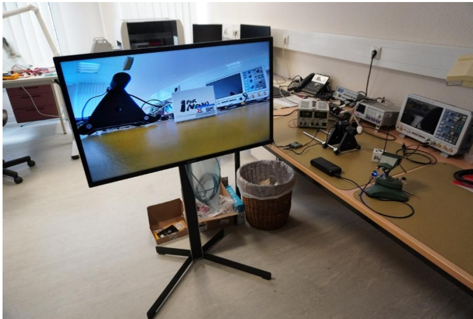
Abbildung 33 Ausgabe des per Analogfunk übertragenen CVBS auf einem Fernseher
