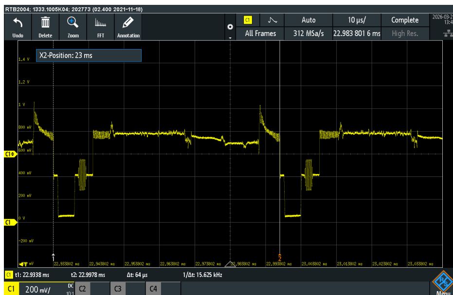
Abbildung 28 Oszillogramm einer Bildzeile des CVBS der Kamera, mit Messung der Bildzeilendauer
