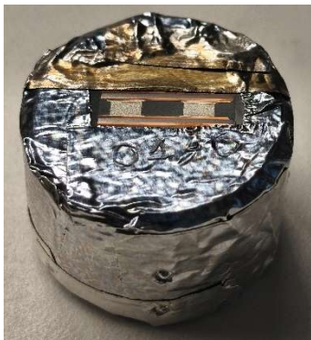
Abbildung 13: eingebetteter Siliziumchip, präpariert, von Fraunhofer ENAS
