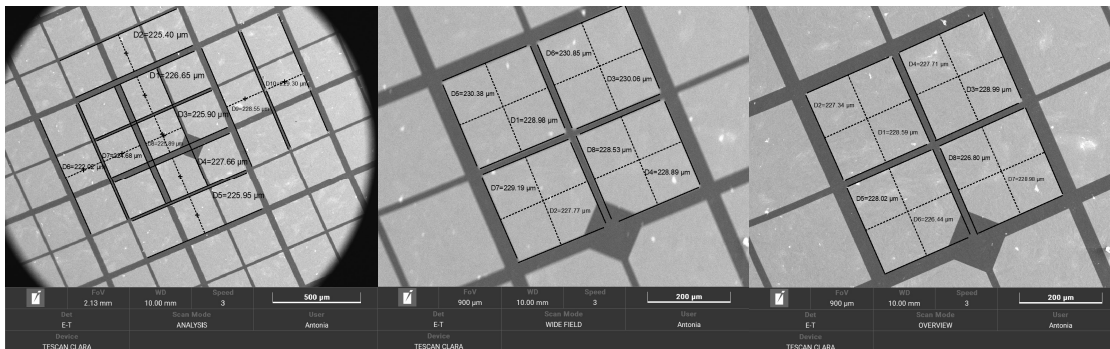
Abbildung 55, 57 und 58: „Analysis“- , „Wide Field“- und „Overview“- Abbildungsmodus; Hochauflösendstestobjekt
