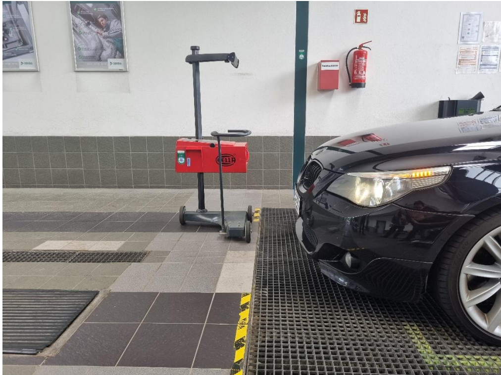
Bild 36: Positionierung eines analogen Scheinwerfer-Einstellgeräts vor dem Fahrzeug zur Vorbereitung der Scheinwerferprüfung [eigene Darstellung]
