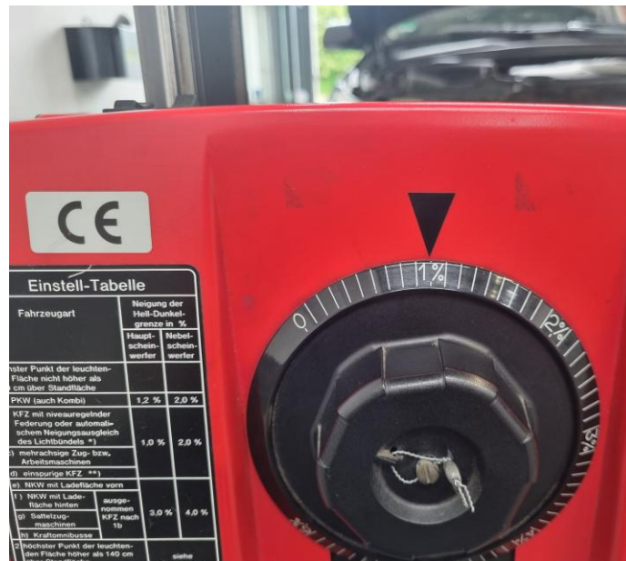
Bild 34: Einstellung des analogen Scheinwerfer-Prüfgeräts auf 1,0 % Neigung [eigene Darstellung]
