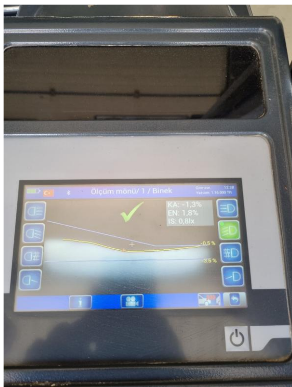
Bild 48: Positives Messergebnis der digitalen Scheinwerferprüfung in der TÜVTÜRK- Fahrzeugprüfstelle (Türkei) [eigene Darstellung]
