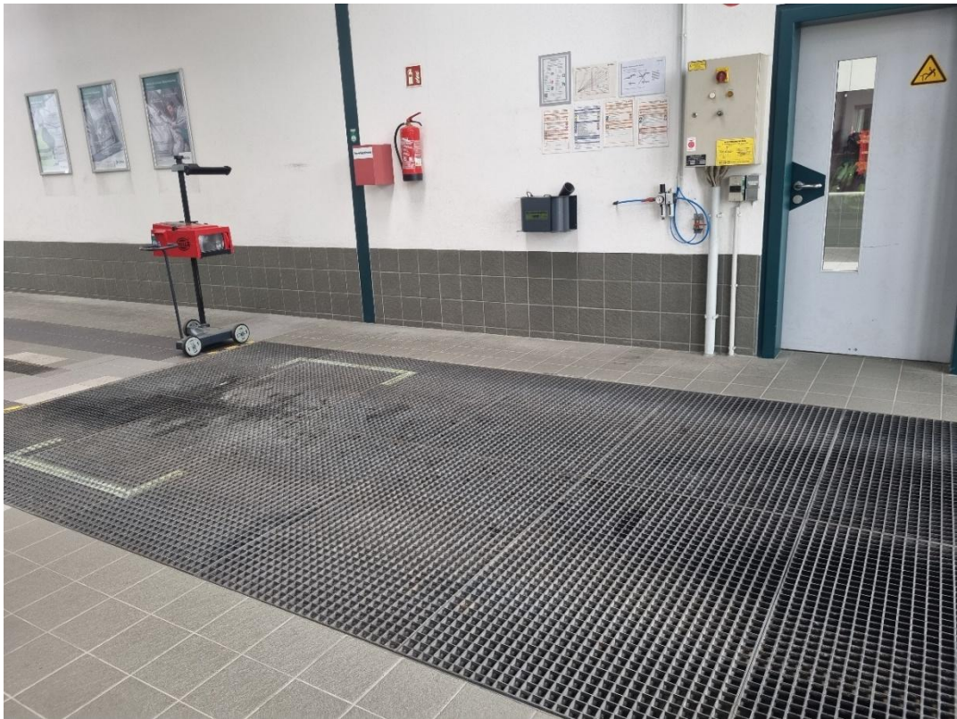
Bild 29: Prüfraum für die Scheinwerferüberprüfung (DEKRA-Werkstatt, Deutschland) [eigene Darstellung]
