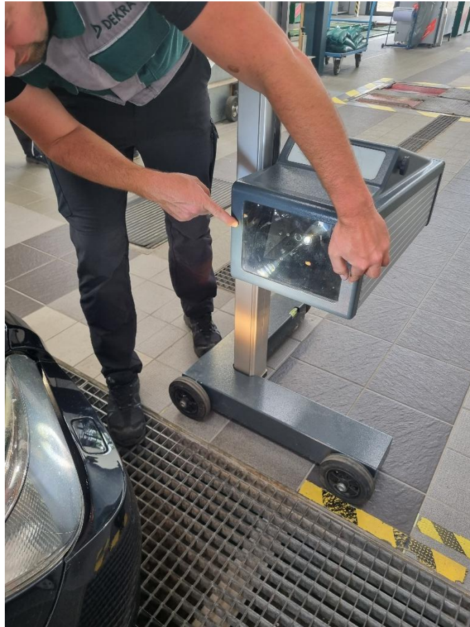
Bild 40: Durchführung der Scheinwerferprüfung am Fahrzeug mit dem digitalen Prüfgerät MAHA MLT 3000 [eigene Darstellung]
