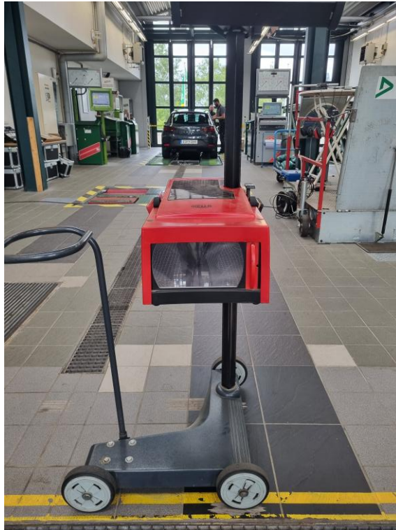
Bild 31: Analoges Scheinwerfer-Prüfgerät HELLA (Typ 8PA 007 732-01) zur manuellen Lichtneigungseinstellung in der Werkstatt [eigene Darstellung]
