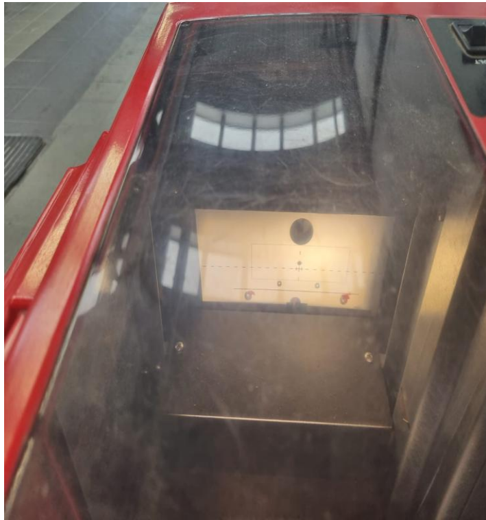
Figure 39: Falsche Einstellung des Abblendlichts – Lichtkegel oberhalb der Soll-Linie beim analogem HELLA-Prüfgerät [eigene Darstellung]
