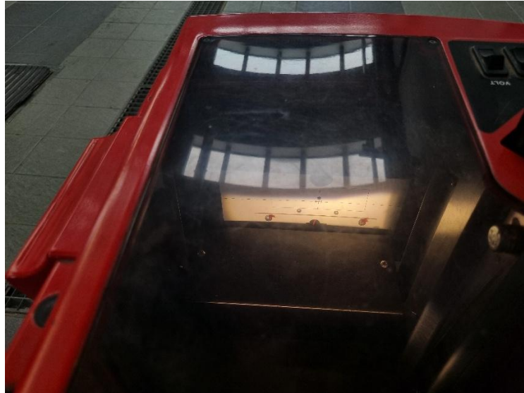
Bild 37: Messergebnis der Scheinwerferprüfung mit dem analogen HELLA-Prüfgerät – innerhalb der zulässigen Toleranz (in Ordnung) [eigene Darstellung]
