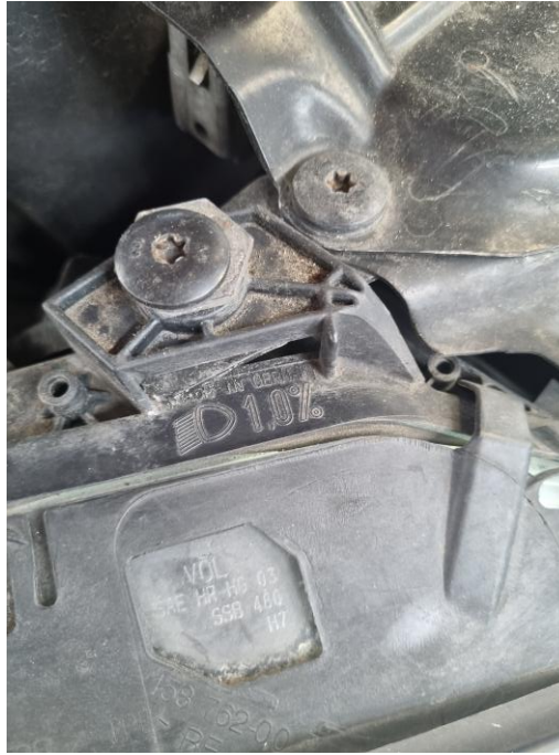
Bild 30: Herstellerkennzeichnung und Neigungsangabe am Scheinwerfergehäuse [eigene Darstellung]
