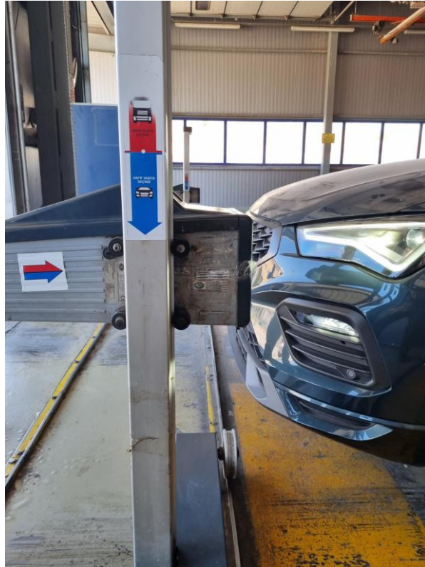
Bild 45: Durchführung der digitalen Scheinwerferprüfung in der TÜVTÜRK- Fahrzeugprüfstelle (Türkei) [eigene Darstellung]
