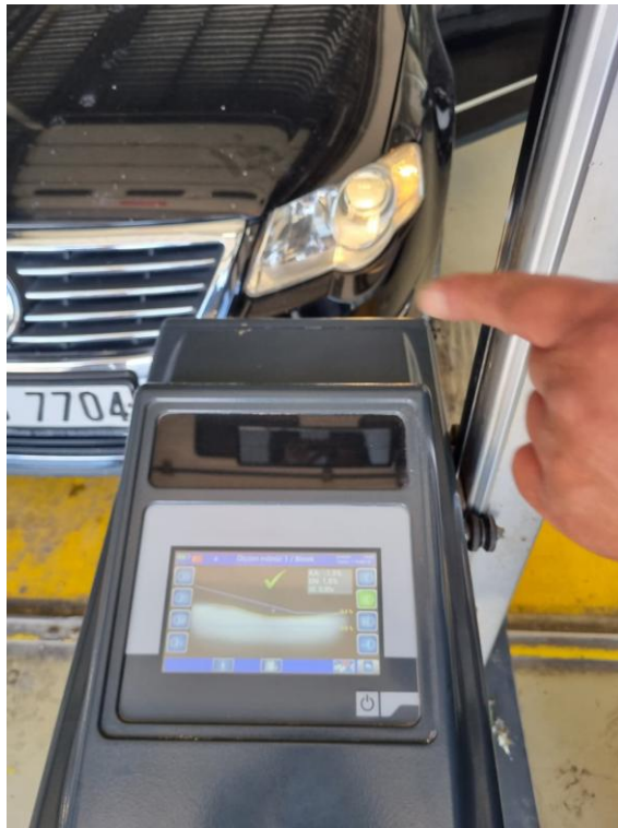
Bild 47: Positives Messergebnis der digitalen Scheinwerferprüfung in der TÜVTÜRK- Fahrzeugprüfstelle (Türkei) [eigene Darstellung]
