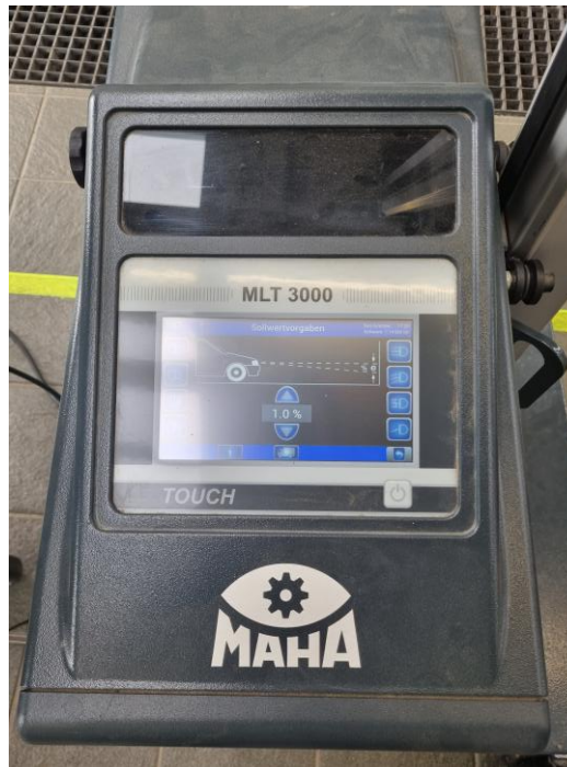
Bild 35: Einstellung des digitalen Scheinwerfer-Prüfgeräts MAHA MLT 3000 auf den Sollwert von 1,0 % [eigene Darstellung]
