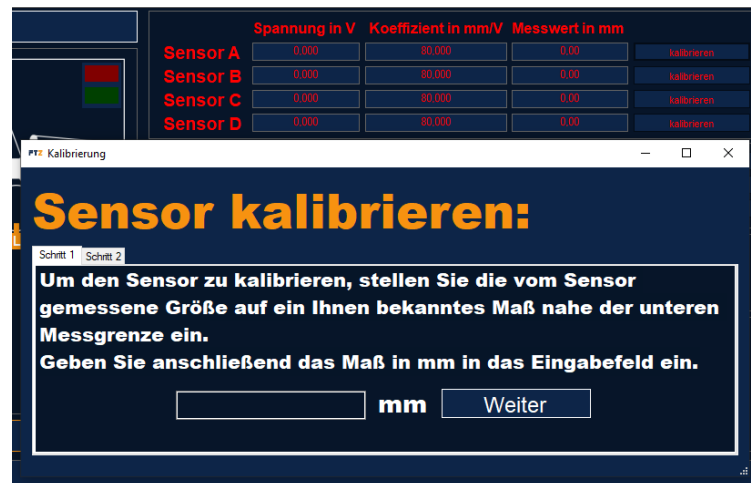
Abbildung 10.3.: Screenshot der Sensorkalibrierung in der neu entwickelten Software
