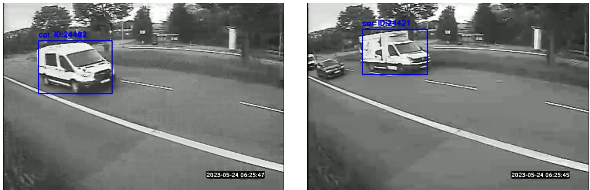
(a) Transporter Kastenausführung korrekt als Pkw klassifiziert
