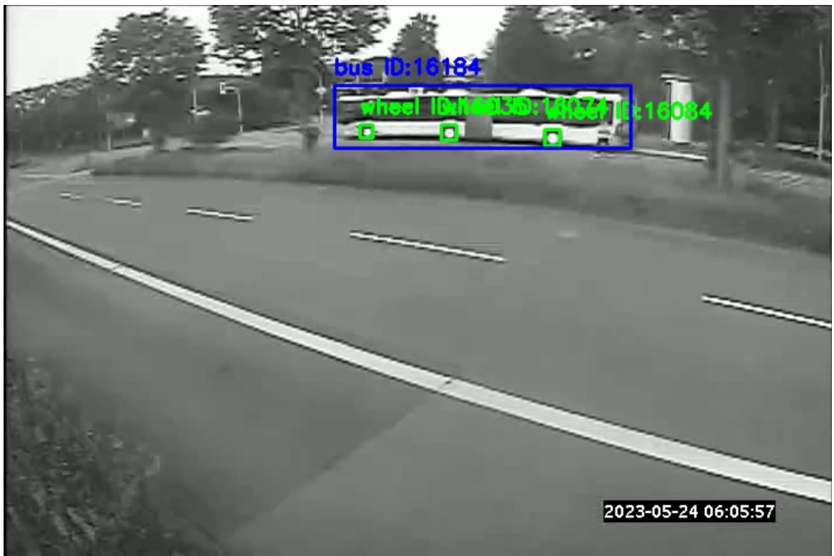
Abbildung 3.16: Gelenkbus mit kantiger Silhouette bei großer Entfernung richtig Klassifiziert. Räder nicht in richtiger Reihenfolge, aber vollständig und präzise erkannt
