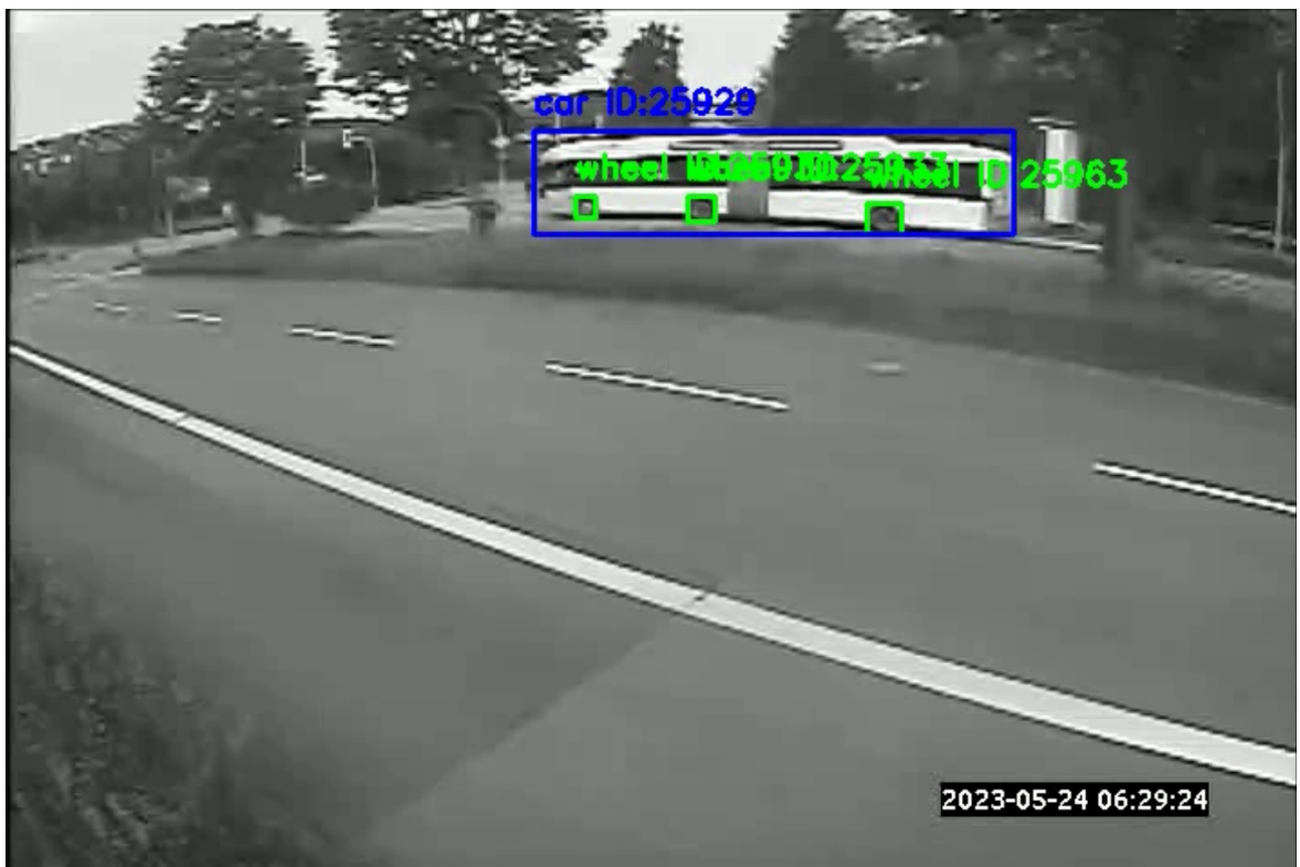
Abbildung 3.17: Gelenkbus mit runder Silhouette falsch als Pkw klassifiziert. Räder nicht in richtiger Reihenfolge, aber vollständig und präzise erkannt
