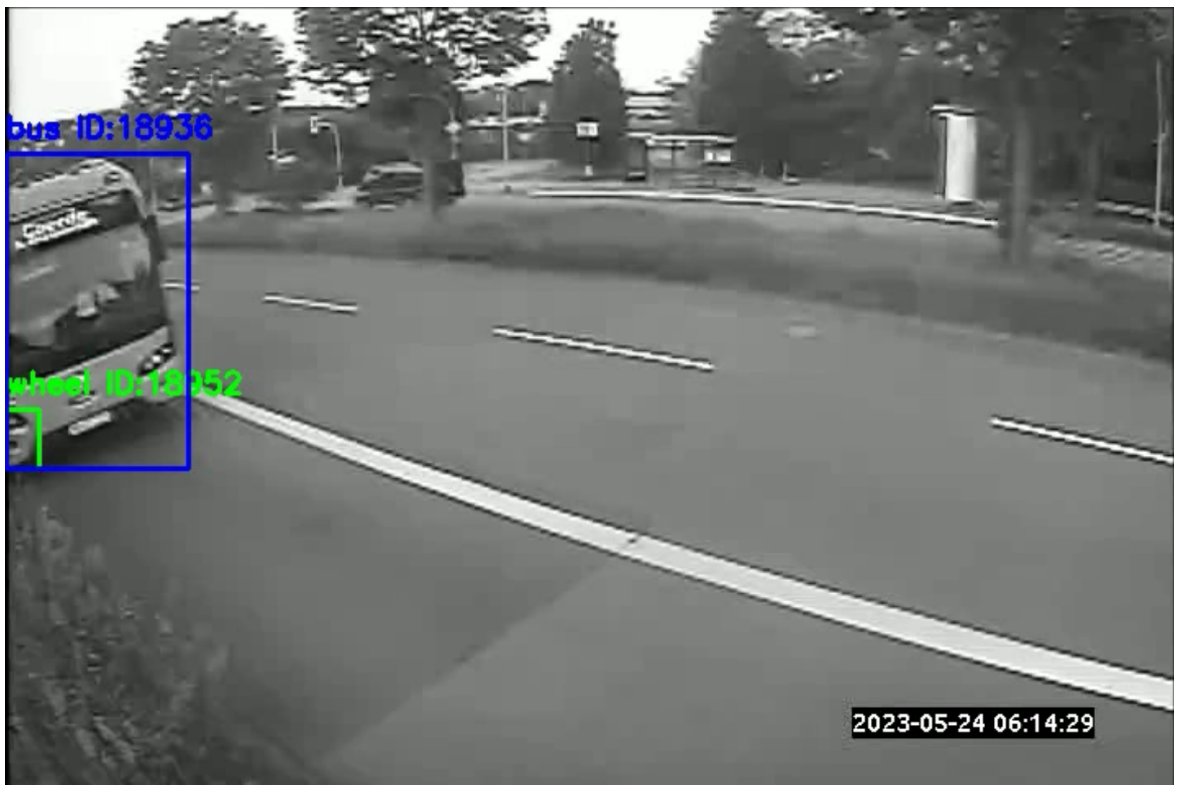
Abbildung 3.14: Falschdetektion eines Rads bei einem Bus am Bildrand
