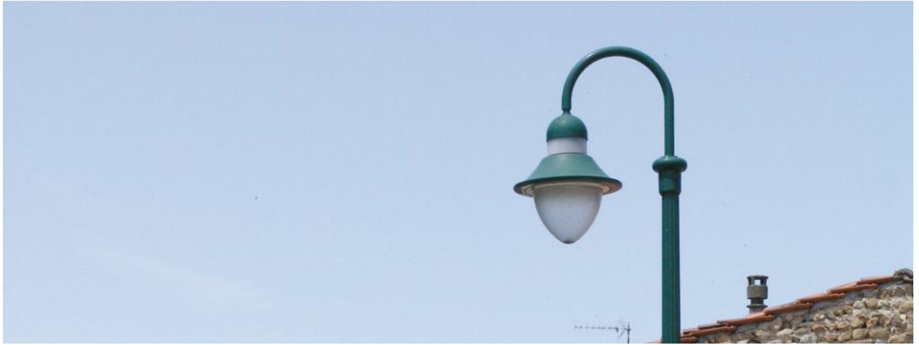
Abbildung 4: Der weiße Ring oberhalb des eigentlichen Leuchtenkörpers der Selux Beta sendet ein zusätzliches Licht aus, welches ohne jegliche Abschirmung in den Himmel leuchtet. [62, Ausschnitt]
