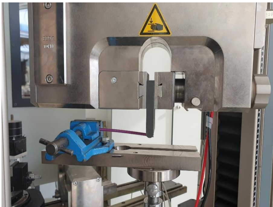
Abbildung 16: Ansicht des Versuchsaufbaus mit eingespannter IntraOS-Schraube große XL und zentraler Lastrolle zur Messung der elastischen Rückwirkungskräfte
