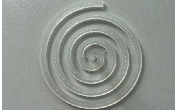
Abbildung 54: Fließspirale mit Fehlern aus PP
