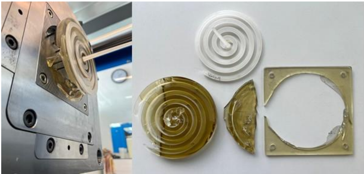
Abbildung 53: Schadensbild des Visijet-HT-250 Formeinsatzes
