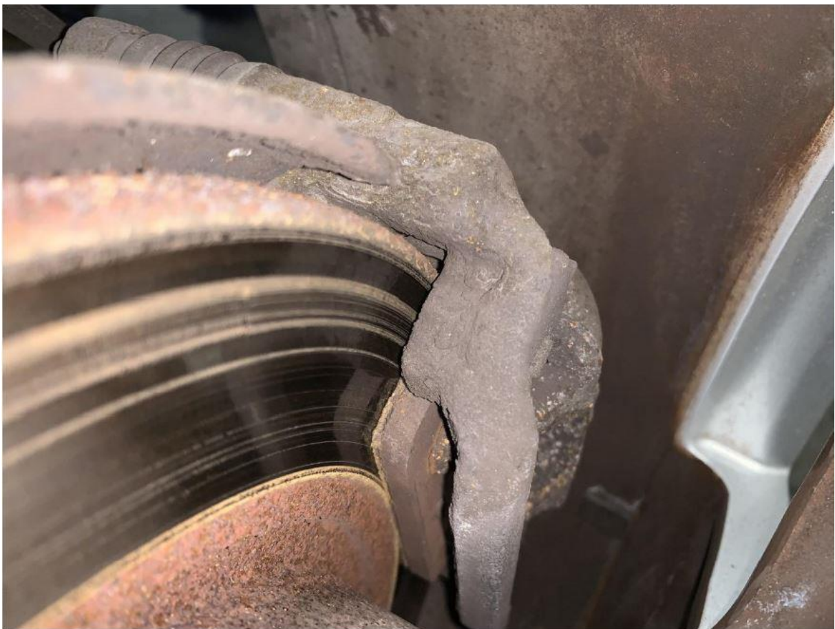
Abbildung 8.2: Verschlissene Bremse, „Erheblicher Mangel“
