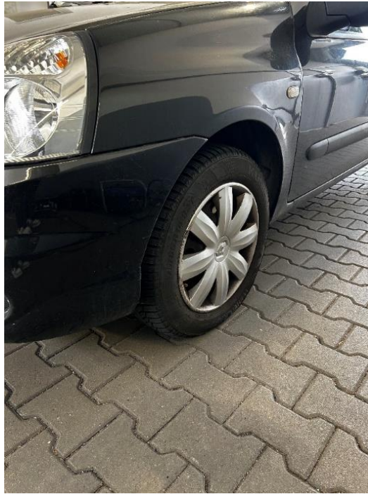
Abbildung 10.5: Versuchsfahrzeug mit niedrigem Reifendruck (0,8 Bar unter Werksvorgabe)
