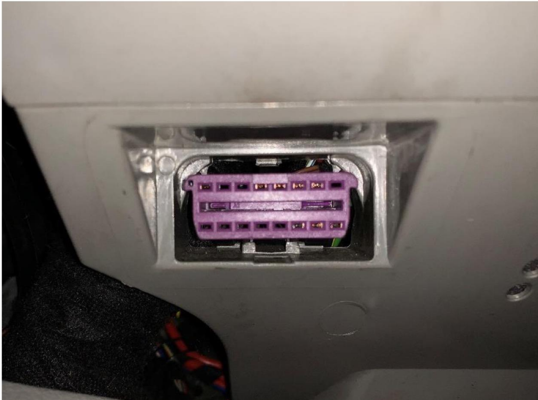
Abbildung 6.10: OBD-Schnittstelle vom Audi A4 (Erstzulassung 2005)
