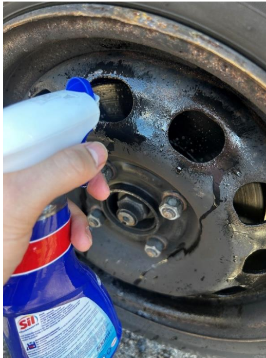
Abbildung 10.14: Salz-Wasser Gemisch auf der Bremsscheibe vorne links
