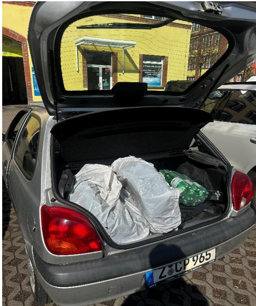
Abbildung 10.13: Versuchsfahrzeug mit Zusatzlast auf der Hinterachse
