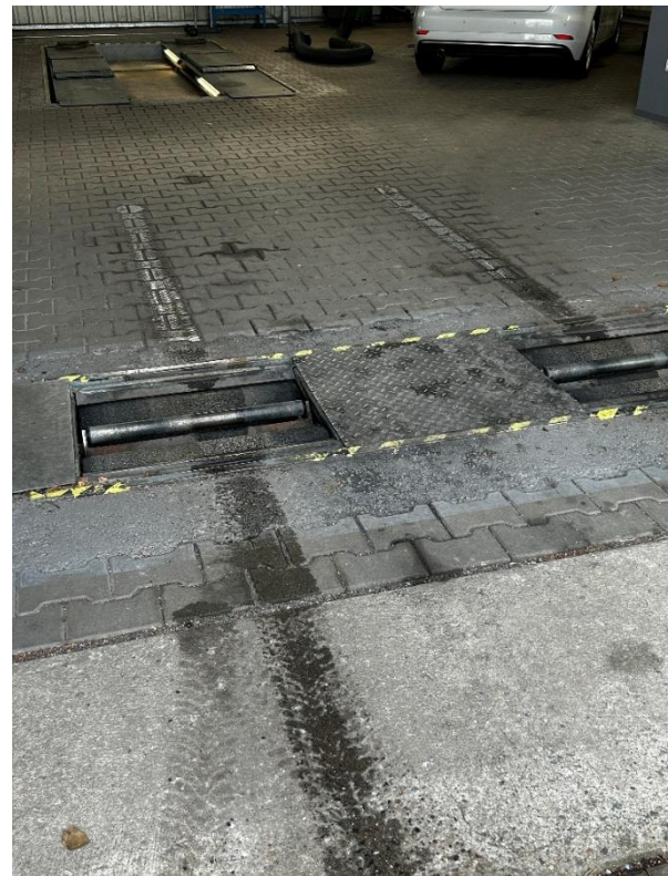
Abbildung 10.18: Feucht durchfahrener Rollenbremsprüfstand
