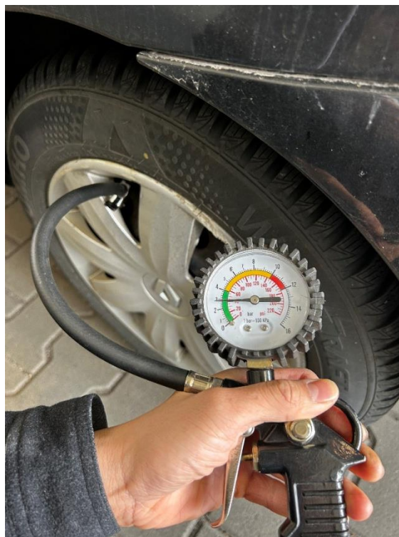
Abbildung 10.6: Reifen mit +0,2 bar über dem „Werksdruck“
