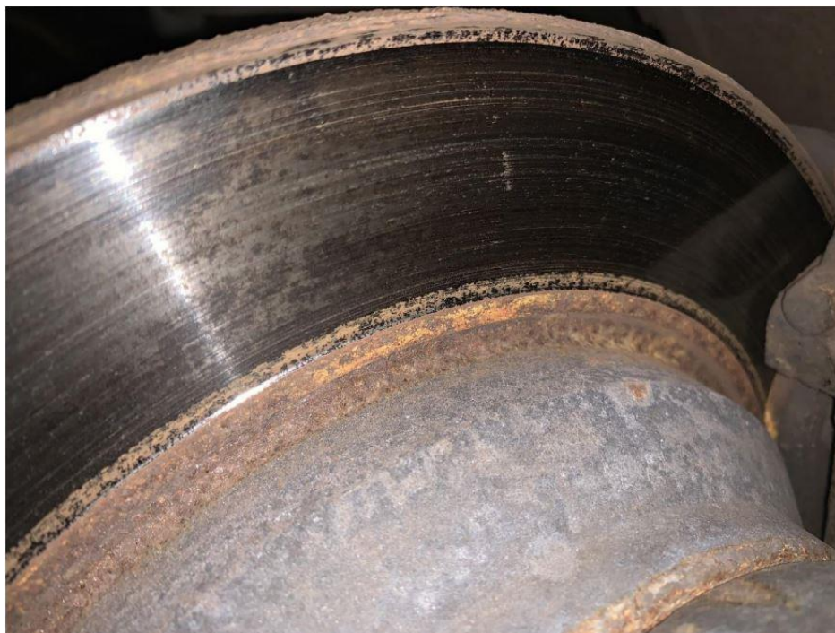
Abbildung 8.1 Bremse mit normalem Verschleiß, „ohne Mängel“
