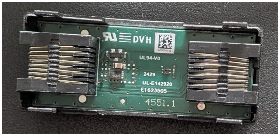
Abbildung 4.1: Sensoreinheit zur Klimadatenerfassung
