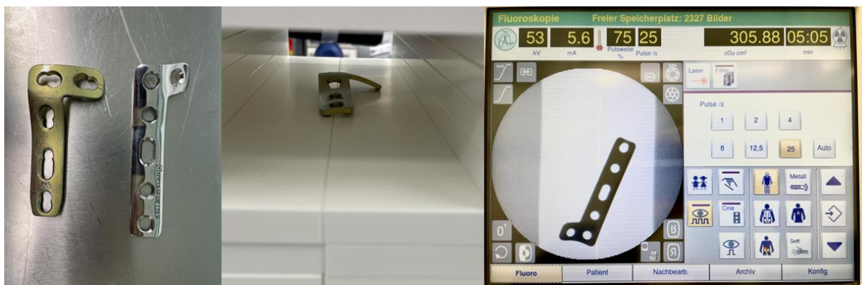
Abb. 29: Auf dem ersten Bild sind L-förmige Knochenplatten ähnlicher Größe zu sehen. Die linke ist aus Titan und die rechte aus Stahl, beide sind 2 mm dick. Das zweite und dritte Bild zeigen je eine Knochenplatte im Phantom und als aufgenommenes Röntgenbild.
