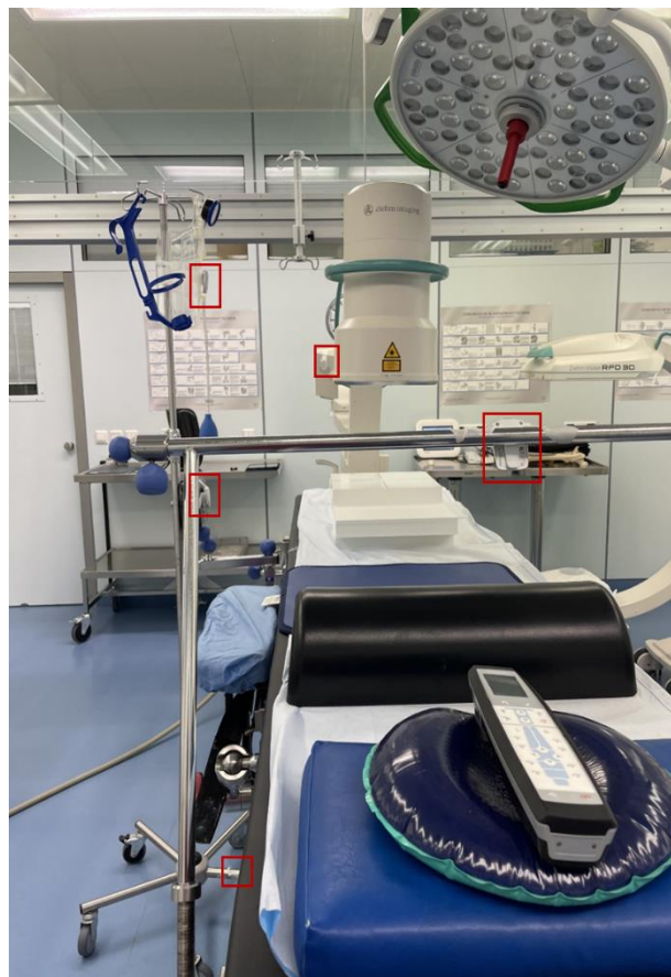
Abb. 25: Versuchsaufbau Phantommessung p.a., rot markiert sind die Positionen der Dosimeter.
