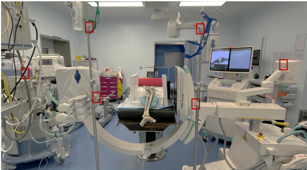
Abb. 32: Versuchsaufbau Phantommessung horizontal, rot markiert sind die Positionen der Dosimeter.
