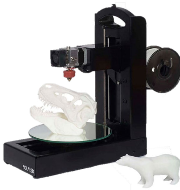
Abbildung 24: 3D-Drucker von Polar3D mit polaren Bewegungssystem /34/
