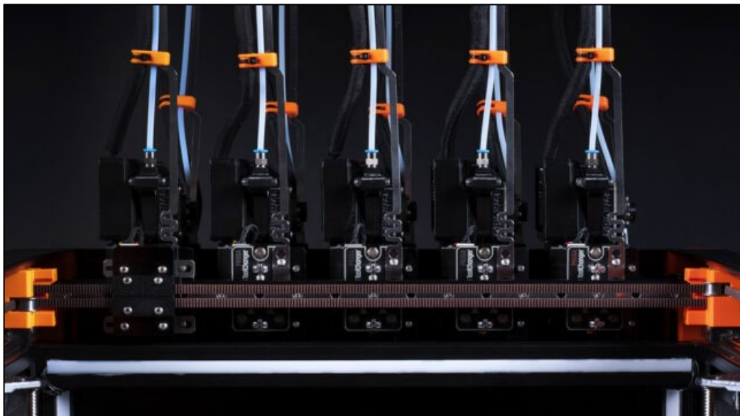
Abbildung 11: Werkzeugwechsler im Prusa XL /24/
