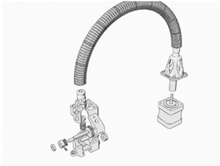
Abbildung 19: Konzeptdarstellung des Biegewellen-Extruders Flex3Drive von Mutkey3D /31/
