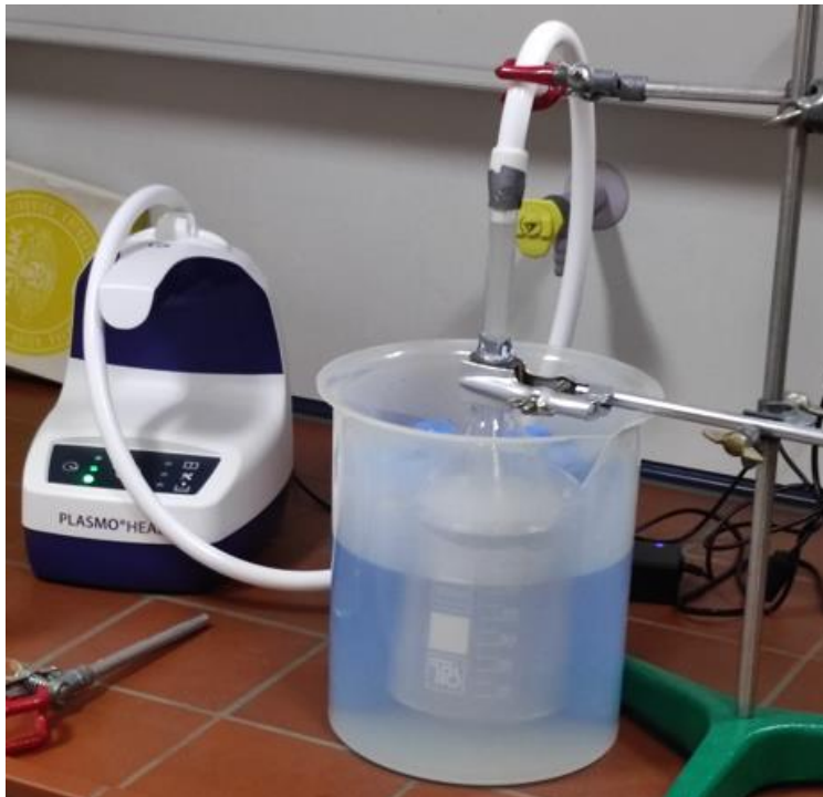
Abbildung 14 Aufbau der Kondensation des Kaltplasmaareosols
