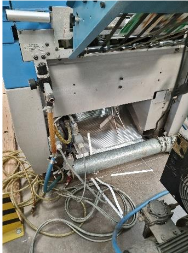
Abbildung 2: Rohr mit Absaugöffnung zur Papieraufnahme [2]
