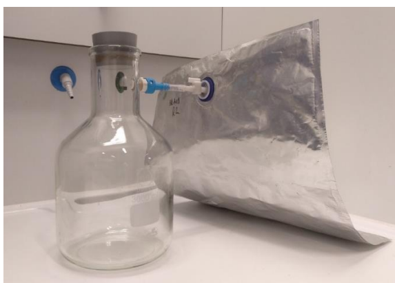
Abbildung 6: Versuchsaufbau zur Bestimmung des entweichenden Gasvolumens
