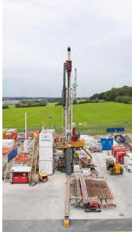
Abbildung 11: Flächenbedarf eines einfachen Fracking-Bohrplatzes (NEUTRALER EXPERTENKREIS 2012: 24)
