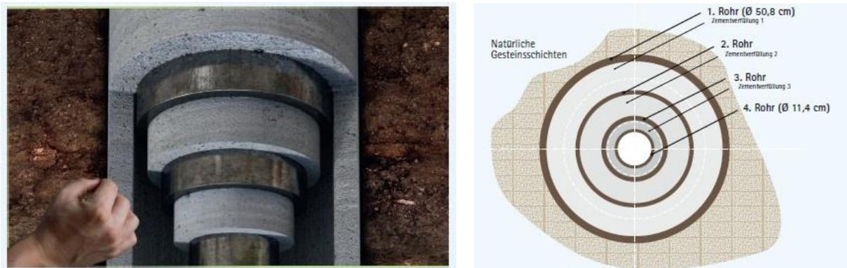
Abbildung 5: Aufbau eines Bohrlochs im Querschnitt bei einer Tiefe von 1.000 Metern (NEUTRALER EXPERTENKREIS 2012: 32/33)
