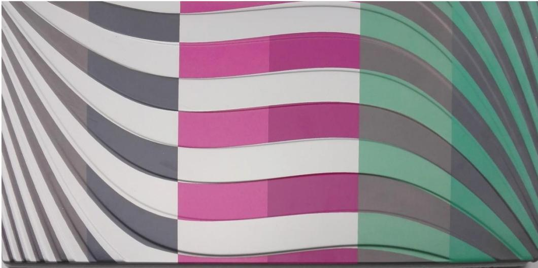
UV-Druck Farbversuche abwechselnd mit und ohne weißen Unterdruck auf einer silbernen Edelstahlfliese,
